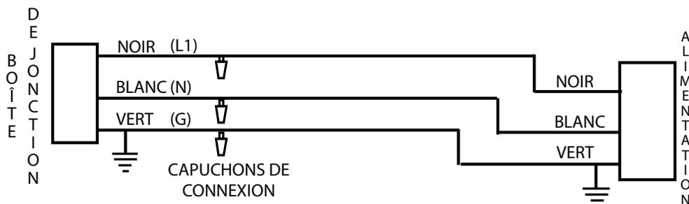
**REMARQUE** Laissez une longueur de fils suffisante pour que l'appareil puisse être retiré de l'enceinte sans le débrancher du circuit d'alimentation.
